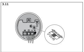
3.11 Réglez le volume émis, à l'aide de la commande de volume d'émission située sur le socle. Faites glisser progressivement la commande d'une position à l'autre, jusqu'à ce que votre interlocuteur confirme que le niveau sonore est convenable. <sup>1)</sup>
